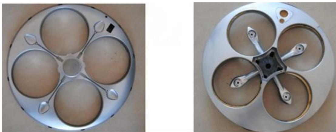
图35 基于IMD/OMD技术的发泡材料表面装饰工艺
